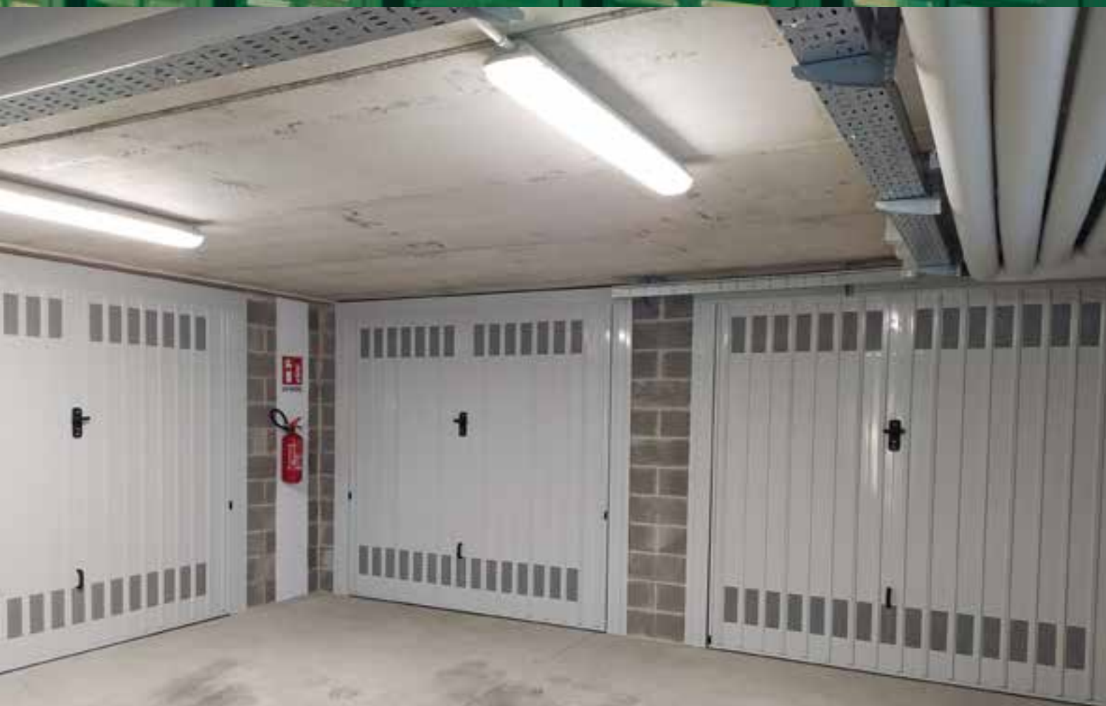
Basculante in ferro con asole superiori e inferiori • RAL 9010
